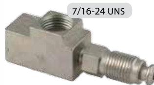
BQ378 Swivel Tee M10 × 1 port 7/16-24 UNS port M10 × 1 tube nut, DIN flare
